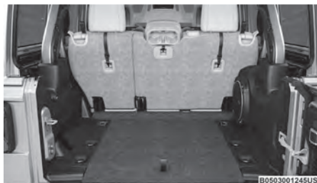
נקודות עיגון לרצועת קשירה עליונה (דגמי ארבע דלתות עם משענת יד מרכזית)
