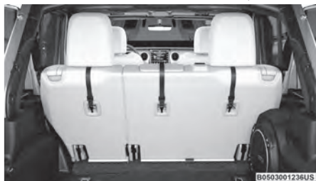
נקודות עיגון לרצועת קשירה עליונה (דגמי ארבע דלתות ללא משענת יד מרכזית)
