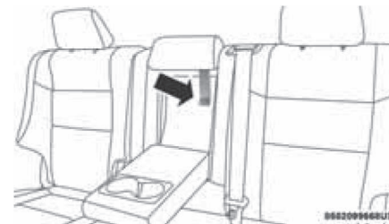
2. משוך את הרצועה על מנת לנתקה מכיסוי הפלסטיק. רצועת קשירה של משענת היד במושב המרכזי
