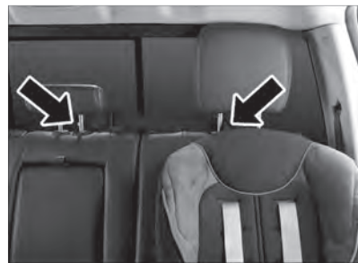
רצועת קשירה דרך לולאת רצועת קשירה צדדית המחוברת לולאת רצועת קשירה מרכזית
